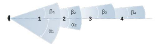
L'apertura di ogni campo è regolabile dinamicamente con incrementi di 5° in un range compreso tra 10° e 100°.
