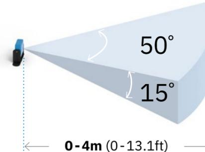
**2. FOV Ampio 0 - 4m** [distanza min config.: 1m]
