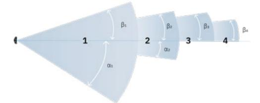
L'apertura di ogni campo è regolabile dinamicamente con incrementi di 5° in un range compreso tra 10° e 100° (0.5 - 5 m) e in un range compreso tra 10° e 40° (5 - 9 m).
