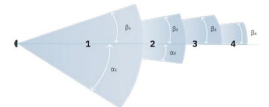
L'apertura di ogni campo è regolabile dinamicamente con incrementi di 5° in un range compreso tra 10° e 100° (0.5 - 5 m) e in un range compreso tra 10° e 40° (5 - 9 m).
