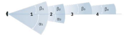
L'apertura di ogni campo è regolabile dinamicamente con incrementi di 5° in un range compreso tra 10° e 100°.
