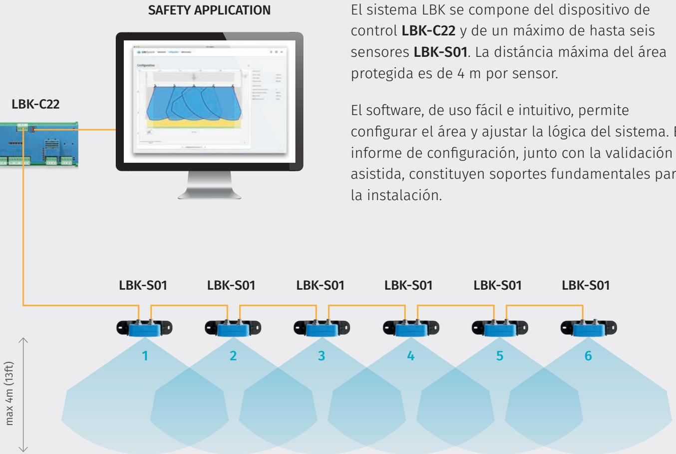
El sistema LBK se compone del dispositivo de control **LBK-C22** y de un máximo de hasta seis sensores **LBK-S01**. La distancia máxima del área protegida es de 4 m por sensor.
